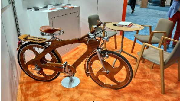
จักรยานทำจากไม้ไผ่เกือบทั้งคันใช้ขับเคลื่อนได้จริง แสดงถึงความแข็งแรงของไม้ที่ใช้
